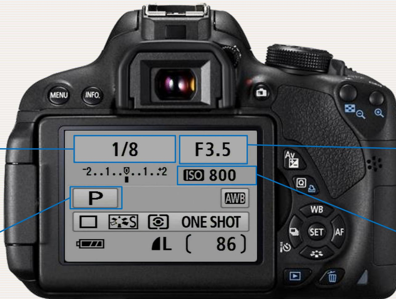
**快门速度**：显示快门打开的时间。分母数值越大，则快门打开时间越短。
