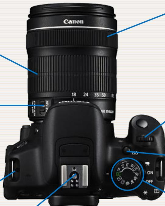
**对焦环：**采用手动对焦（**MF**）模式时，旋转该环进行**对焦**。对焦环的位置因镜头而异。
