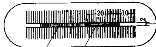
泡沫密封接缝 翼缘构造 铜质薄片 镀锌铁圈 贴面接缝处理
