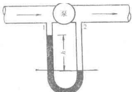
中安装水银压差计，测得  $h = 120 \text{ mm}$ ，问水经过水泵后压强增加多少？若为风管，则水泵换为风机，压强增加多少  $\text{mmH}_2\text{O}$ 。
