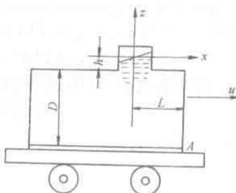
全停下。若考虑为均匀制动，求作用在侧面 A 上的作用力。
