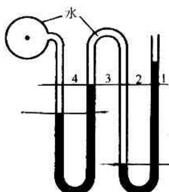
13. 一封闭容器盛有  $\gamma_2$ (水银)  $> \gamma_1$ (水) 的两种不同的液体。试问同一水平线上的 1, 2, 3, 4, 5 各点的压强哪点最大? 哪点最小? 哪些点相等?
