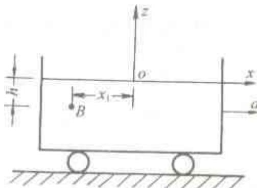
45. 油罐车内装着  $\gamma = 9807 \text{ N/m}^3$  的液体，以水平直线速度  $u = 10 \text{ m/s}$  行驶。
