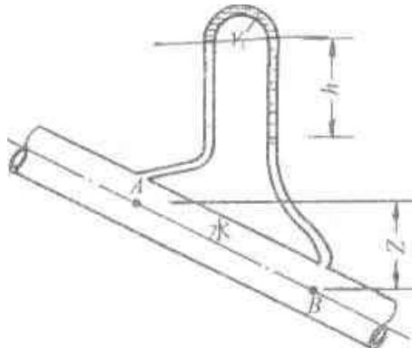
21. A, B 两管的轴心在同一水平线上，用水银压差计测定压差。测得  $\Delta h = 13 \text{ cm}$ ，当 A, B 两管通过 (1) 为水时；(2) 为煤气时，试分别求压差。
