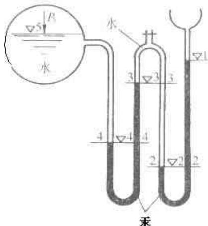
20. 图为倾斜水管上测定压差的装置，测得  $Z = 200 \text{ mm}$ ,  $h = 120 \text{ mm}$ , 当 (1)  $\gamma_1 = 9.02 \text{ kN/m}^3$  为油时；(2)  $\gamma_1$  为空气时，分别 A, B 两点的压差。
